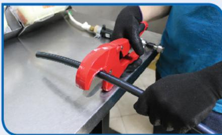
1. Corte el tubo en el extremo a usar, asegurando que el corte esté derecho y limpio (sin rebabas ni marcas de la herramienta de corte).
