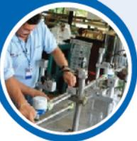
El objetivo de esta prueba es evidenciar la ausencia de fugas en el accesorio de resina termoplástica, conectando el producto a una línea de agua para hacer oscilar la presión del fluido a la presión de trabajo del accesorio y hasta tres veces esta presión.
